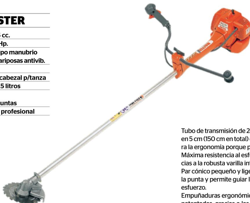
Tubo de transmisión de 24 mm de diámetro y longitud aumentada en 5 cm (150 cm en total) que reduce el peso de la máquina y mejora la ergonomía porque permite trabajar en posición más erguida. Máxima resistencia al esfuerzo y calidad constante del trabajo gracias a la robusta varilla interior de transmisión de 7 mm.
